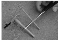
Messdübel und Stab auf Messtiefe zuschneiden
