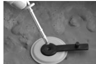
Stab entfernen, wenn der Beton trocken ist
