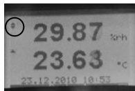
Verificare la stabilità del valore (indicatore di tendenza) prima di memorizzare i dati
