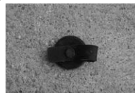
Inserire il manicotto nel foro di prova e chiudere il tappo
