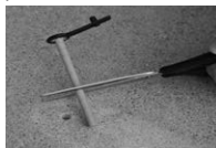
Tagliare il manicotto conformemente alla profondità di misura
