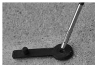
Inserire la sonda in sito nel manicotto
