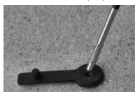
Insertar la sonda in situ en el manguito
