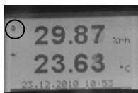
Esperar valor estable (indicador de tendencia) antes de registrar datos
