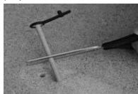
Cortar el manguito conforme a la profundidad de medición
