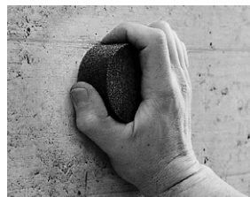
Fig. 2.1 Préparer la surface à examiner
