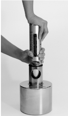
Fig. 3.1 Funktionskontrolle des Betonprüfhammers (Modell N/L abgebildet)
