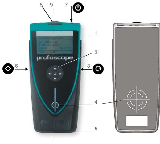
Das Profoscope lässt sich mit einer Hand bedienen. Alle Funktionen können über zwei Funktions- und die Navigationstasten programmiert/aufgerufen werden.
