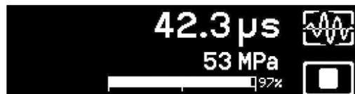
Medição da resistência à compressão (Pundit Lab+)
