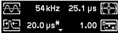
Frequência da transmissão, calibração, largura de pulso, correção da temperatura
