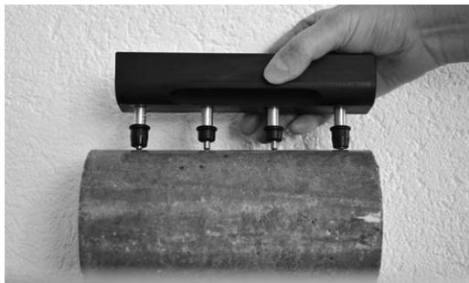
Une bonne connexion entre l'instrument et la surface du béton est le facteur le plus important pour obtenir une mesure fiable. Plonger les contacts dans l'eau plusieurs fois avant d'effectuer une mesure – utiliser un récipient peu profond de telle façon que vous puissiez les appuyer au fond – vous remplirez ainsi les réservoirs. Appuyer le Resipod fermement vers le bas jusqu'à ce que les deux capuchons de caoutchouc reposent sur la surface à mesurer.
