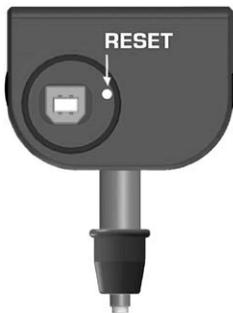
Un petit bouton de réinitialisation est situé sous le couvercle étanche de la prise USB. Si l'instrument s'est verrouillé ou ne répond pas, appuyer sur ce bouton avec un trombone permettra d'effectuer une réinitialisation.
