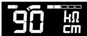
Les cinq segments lit indiquent que les 200  $\mu$ A ou 50  $\mu$ A sont envoyés dans l'objet à tester. Si c'est possible, (voir ci-dessus), l'écran indique ce courant sous la forme de la valeur multiple de 10  $\mu$ A la plus proche.
